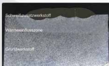
Einlagige Schweißnaht angelassen bei 480 °C
