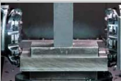
Die Platten werden an allen 6 Seiten gefräst und die Kanten sauber entgratet.
