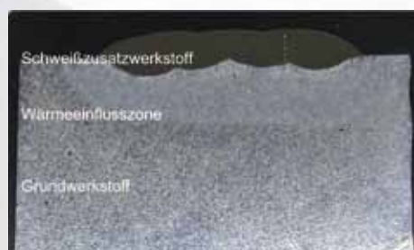
Einlagige Schweißnaht angelassen bei 480 °C
