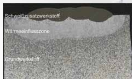
Einlagige Schweißnaht ohne Anlassen
