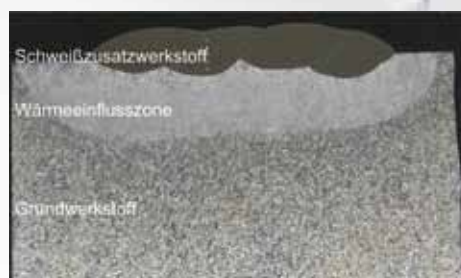
Einlagige Schweißnaht ohne Anlassen
